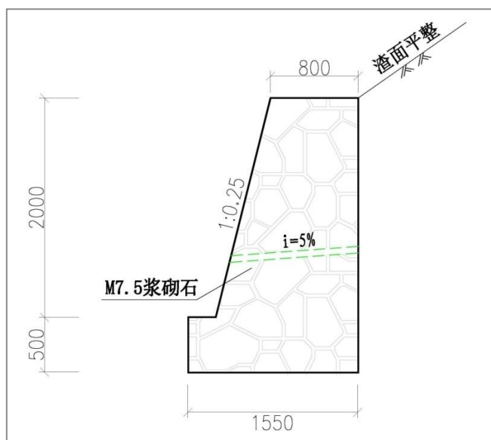
图 5-4 拦渣挡墙断面设计图
