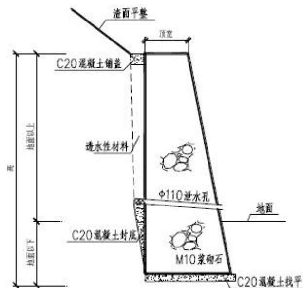
图 5-6 挡墙断面设计大样图
